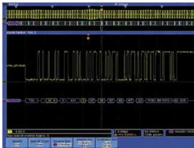
图 42. 触发帧号和循环数，搜索采集的数据，找到启动帧。
