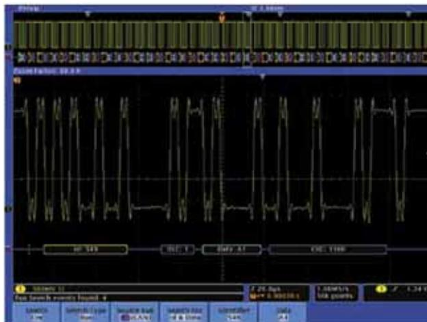
图 44. 在 CAN 总线采集中搜索指定标识符和数据。
