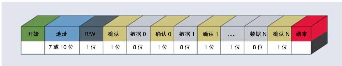
图 4. I<sup>2</sup>C 消息结构。
