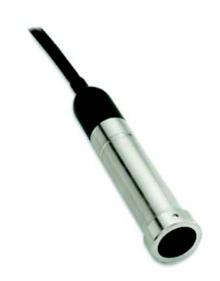
1290 是唯一一款全钛结构且具有本安认证的投入式液位计。坚固且易于安装的1290投入式液位计是专门为废水、泵站/提水站等污水应用设计的。本安认证扩展了产品在危险环境下的应用。先进的微加工硅压阻敏感元件密封在全钛结构中,卓越的性能和出色的抗振动和冲击能力保证了在废水、泵站/提水站、工业、过程和海洋等领域的应用中可靠测量。
