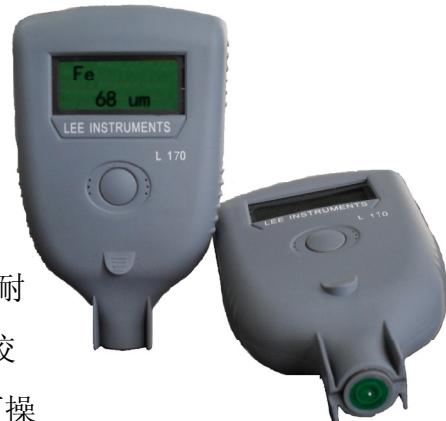
仪器小型紧凑、坚固耐用、用途广泛，可单手操作。该设计便携耐用，使其能在苛刻条件下正常使用。L170 具有一键操作功能，无须校准，也不用重设即可进行下一次测量，无需对操作人员进行培训即可操作。
