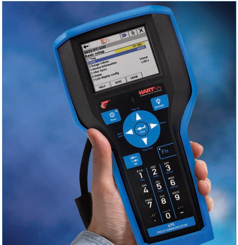
475 现场通讯器适用于所有供应商的 HART and FOUNDATION fieldbus 注册设备。
