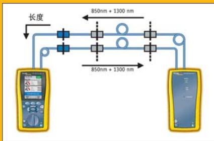
不像其他的光缆测试适配器在每次自动测试时只能进行长度和两次损耗测量，DTX 系列测试仪的光缆适配器是唯一的在一次自动测试中就可完成长度和四次损耗测量的测试方案——只用 12 秒钟。在光缆测试中您可以拥有比其他方案快 5 倍的速度。
