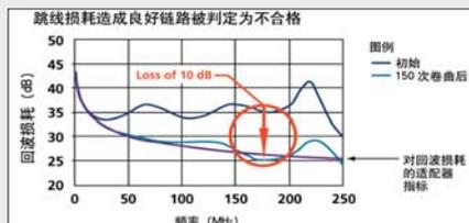
从图中您可以看到，一条商用 7 类 SFTP 跳线在 150 次的卷曲和展开后会有 10dB 的损耗。这 10dB 的损耗会导致合格的链路被误判为不合格——您得到了一个假的不合格结果。如果您使用的是福禄克网络公司的永久链路适配器就不会发生这种情况——DTX 系列测试仪会带给您毋庸置疑的重复测试精度。
