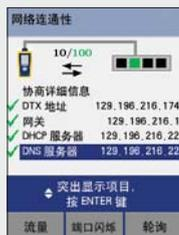
最新推出的 DTX-NSM 网络测试模块为 DTX 系列测试仪增加了网络测试能力。能够通过 DHCP 或手动分配获得 IP 地址，从而测试网络流量，并对网络关键设备进行连通性的 PING 测试。有了 DTX-NSM 网络测试模块，DTX 就不仅能够依照标准认证链路的性能，还可以了解该链路是否已开通了网络服务。在故障诊断中，可以快速区分网络故障还是线缆故障。
