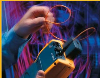
离的光缆故障，并可用于验证连通性和极性。独有的集成式设计确保可视故障定位仪 (VFL) 在您需要的时候随时可以提供帮助。
