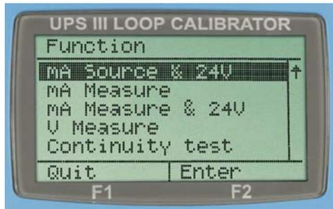
的一个可实现对所有的变送器进行4:1的不确定度比较的回路校验仪，比一般的数字多用表（DMM）的精度高20~80倍。
