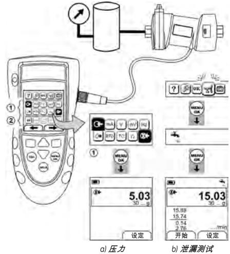
图 13: 示例配置- 压力测量 (使用 UPM)
