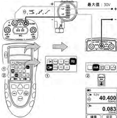
图 10: 示例配置 - 使用外部回路电源的传感器校准
