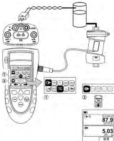
图 14: 示例配置 - 测量压力和温度
