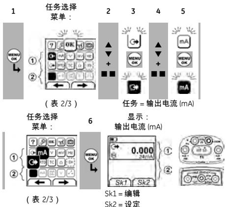
如果向通信端口 (A1- 编号 9) 附加一个通用测量模块 (UMM)，则任务选择菜单将显示适用的 IDOS 选项。
