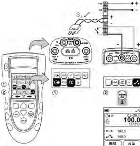
图 12: 示例配置- 交换机测试
