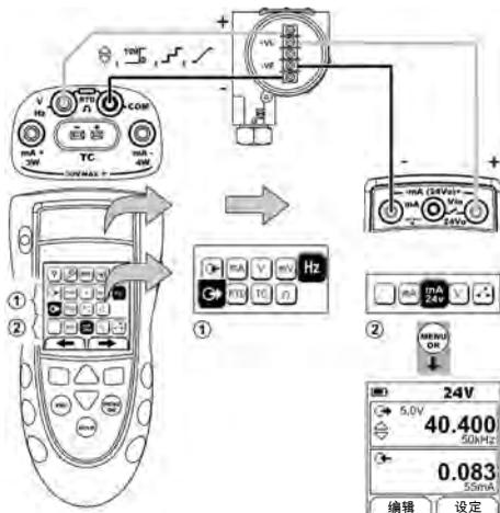
图 11: 示例配置 - 使用内部回路电源的传感器校准
