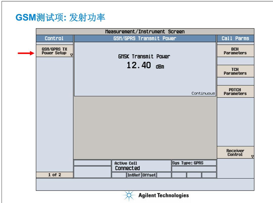
在手机与E5515C保持连接的状态下，在前页提到的测试选择菜单里选择第一项GSM/GPRS Transmit Power就可以得到当前GSM手机所发射的功率值。在测试屏幕上可以读出测试结果。按照测试规范的规定，手机必须按照基站（在测试环境里由E5515C模拟基站）命令手机发送的功率等级来进行发送，即在前面“呼叫参数: TCH参数（1 of 2）”里提到过的MS TX Level（手机发送功率等级）。在上图的例子中，E5515C要求手机发送的功率等级为15级，即13dBm，手机发送的实际功率为12.40dBm，在规范要求的 $\pm 3$  dB的范围之内，所以这一项测试通过。
