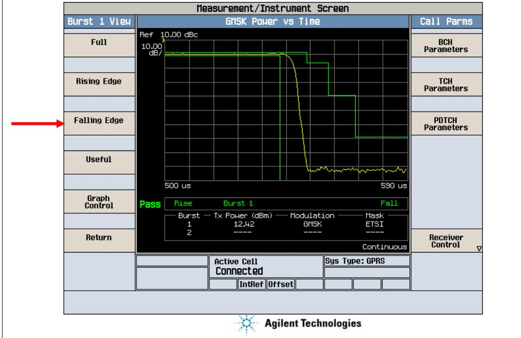
也可以选择“Falling Edge”来观察突发的结束部分，即手机功率开始下降时的下降沿的情况。
