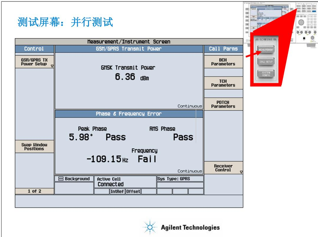
上图所示是并行测试的例子，多项测试同时在E5515C内进行，按 **MEASUREMENT** 按键就可以看到测试的结果，屏幕上同时显示了两项测试的结果：上图是发射功率值，下图是相位及频率误差的结果。
