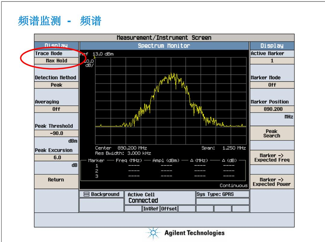
按屏幕下方的Instrument Selection按键，可以选择Spectrum Monitor，即频谱监测，上图是对GSM信号的频谱显示。
