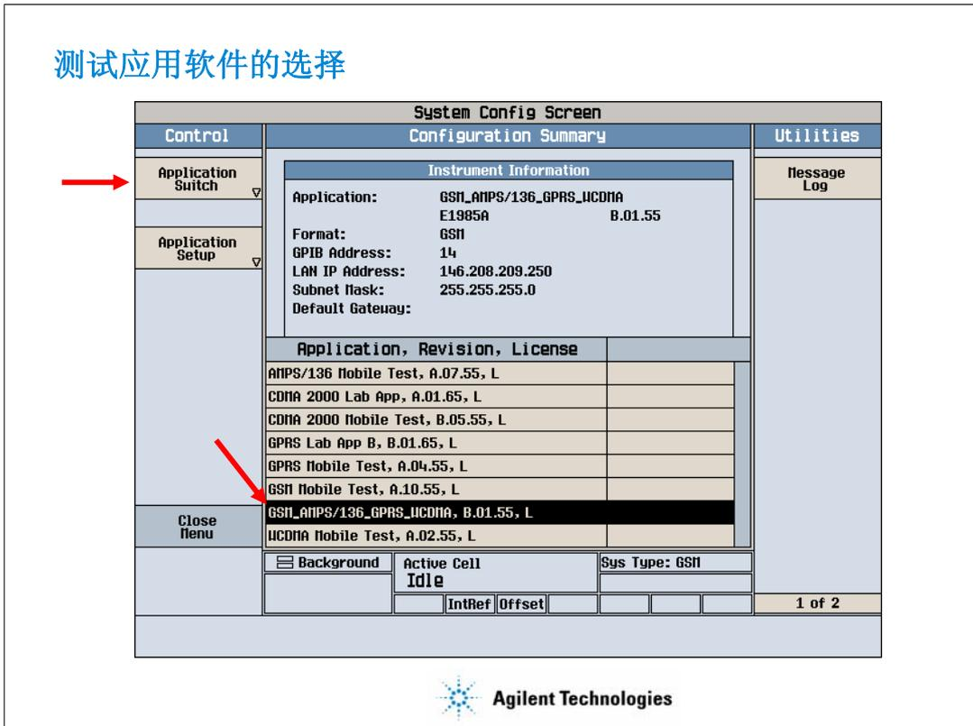
测试应用（TA）是在E5515A/B/C平台上的软件，不同的TA针对不同制式的手机，一台E5515C上面可以有很多的TA，一旦需要对不同制式的手机测试时，就需要按Application Switch键，在弹出菜单里进行不同的TA的选择和切换。
