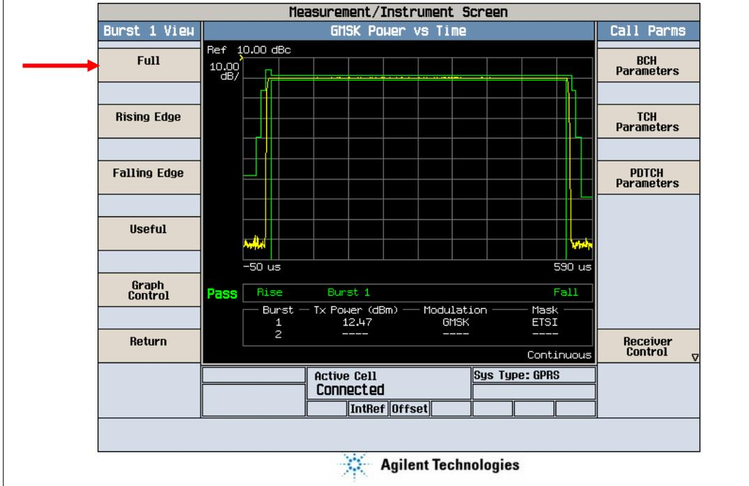
在功率时间关系的图形显示里，可以从多个方面去观察手机的功率随时间变化的情况，上图就是一个全突发的显示（Full）。
