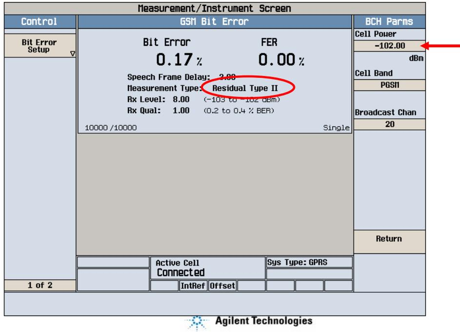
在测试选择菜单里选择“GSM Bit Error”就可以对接收机进行测试，得到比特误码率的结果。上图所示是对接收机进行的灵敏度的测试，在这一项测试里要求将GSM手机的接收机置于小信号的接收环境，即设Cell Power为-102 dBm，在这种状态下要求测试的剩余二类误码率(Residual Type II)小于2%.
