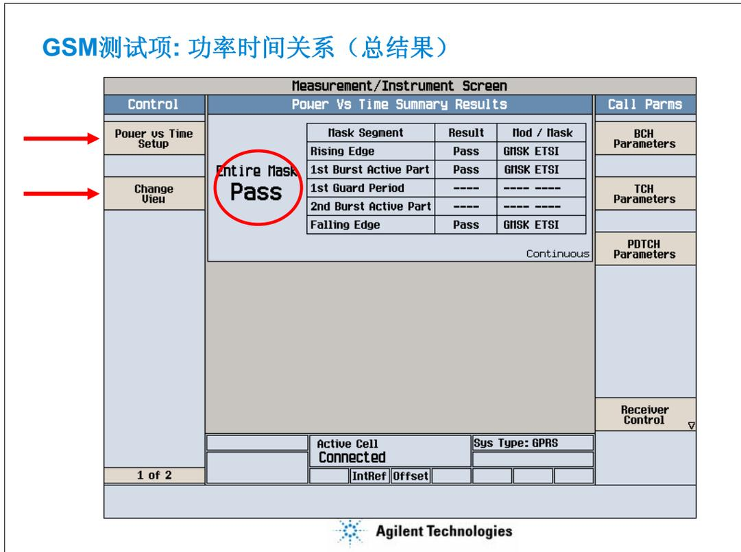
在测试选择菜单里选择了Power vs Time，就可以得到上图所示的对GSM手机的功率时间关系的测试结果。
