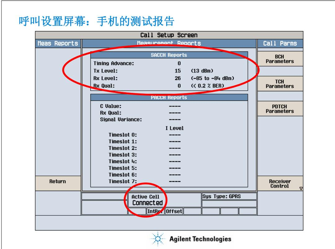
在第二页的菜单上选择手机测试报告（Measurement Reports），可以得到手机在呼叫进行的过程中发给基站的测试报告，包括：手机当时的时间提前值，功率发送电平，手机收到基站信号的接收电平和接收质量。
