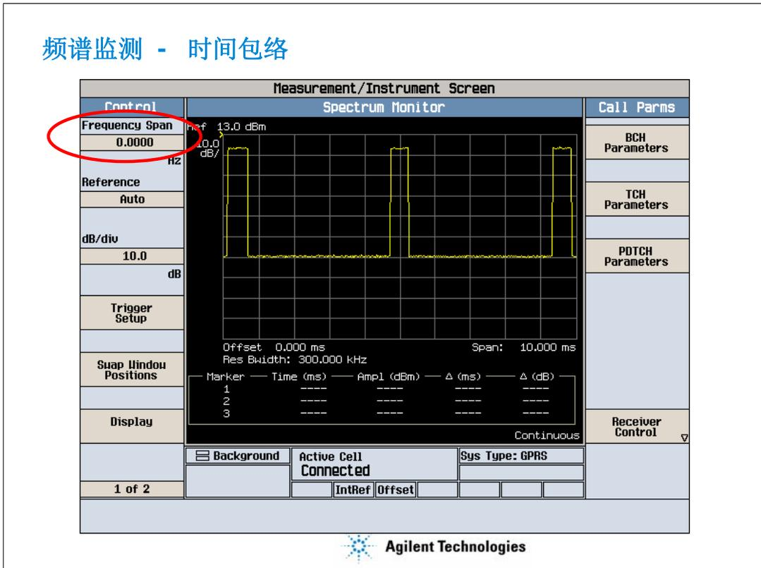
利用频谱监测还可以得到GSM信号的时间包络，如上图所示，可以看到手机每8个时隙发送1个时隙。这是通过将频谱监测的扫宽(Frequency Span)设为0得到的。（在频谱分析仪上，这一项功能叫做零扫宽功能）
