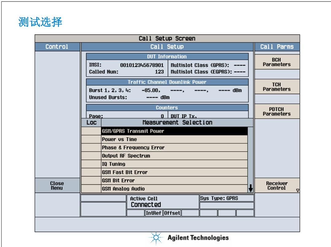
按Measurement Selection键之后，会弹出如上图所示的菜单，可以通过旋钮或是上升下降的按键来选择要进行测试的测试项。E5515C允许多项测试同时进行，而且可以在一屏内同时显示两项测试的结果，所以可以选择多个测试项并行执行。在测试项前面的一列Loc会对选中的测试项相应作出标识，并表明这项测试是否在屏幕上显示出来，以及显示时是在屏幕的上半部分还是下半部分。
