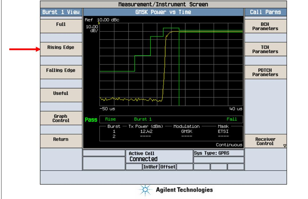
在全突发的图形显示里不容易看清细节，因此可以选择“Rising Edge”来仔细观察突发的开始部分，即手机功率刚开始上升时的上升沿的情况。
