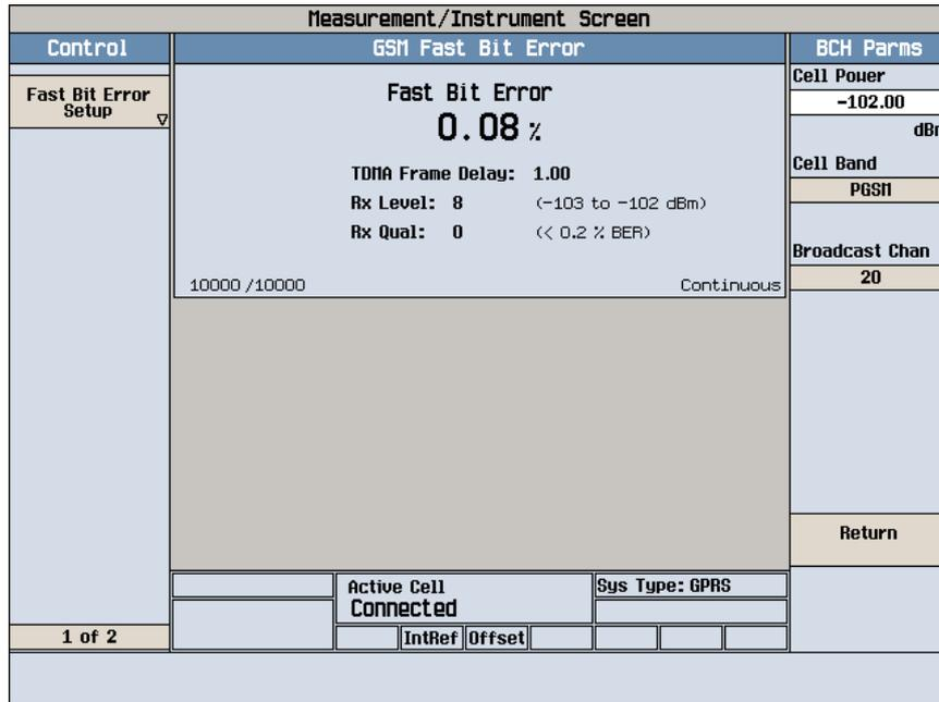
在测试选择菜单里选择“Fast Bit Error”同样可以对接收机进行测试，得到比特误码率的结果。上图所示也是对接收机进行的灵敏度的测试，同样设Cell Power为-102 dBm，要求测试得到的快速比特误码率小于2%。
