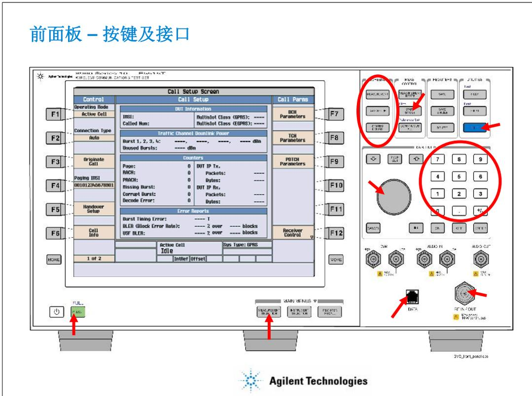
在E5515C的右侧是所谓的“硬”按键，它们都有自己的功能，这些功能标示在按键上。在这些按键里，有三个按键的颜色略深，是“MEASUREMENT”（测试），“CALL SETUP”（呼叫设置），“SYSTEM CONFIG”（系统配置）。按下之后将会同现E5515C的三种主屏幕。
