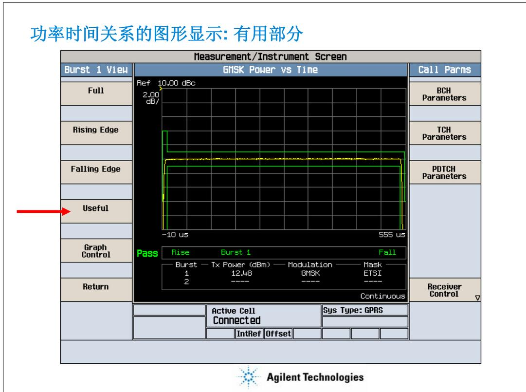
还可以选“Useful”来观察突发的有用部分的情况，也就是在手机真正发送信号的那一段，需要手机的功率保持相对恒定。（功率变化在 $\pm 1$ dBm之内）
