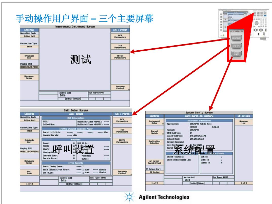
操作E5515C时主要是在三个屏幕里进行的，在测试屏幕里进行测试结果的读取和对测试参数的设置，在呼叫设置屏幕里进行呼叫建立的相关设定，在系统配置里配置仪器地址等参数，选择在E5515C上进行测试的软件从而可以进行不同制式的手机的测试，以及电缆衰减的补偿等。
