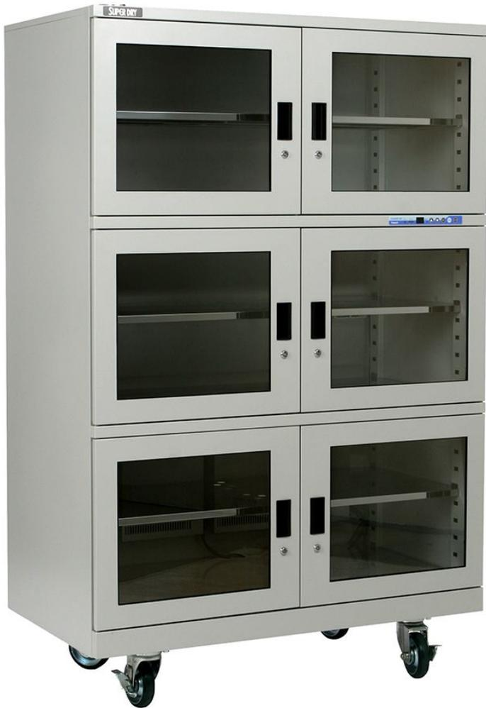
SD-1106-02 内置高效除湿机芯，湿度可精确控制在2%RH以下，特别适合湿敏元器件及PCB的存放，符合IPC/JEDEC J-STD-033C对于湿敏元器件存放的要求。
