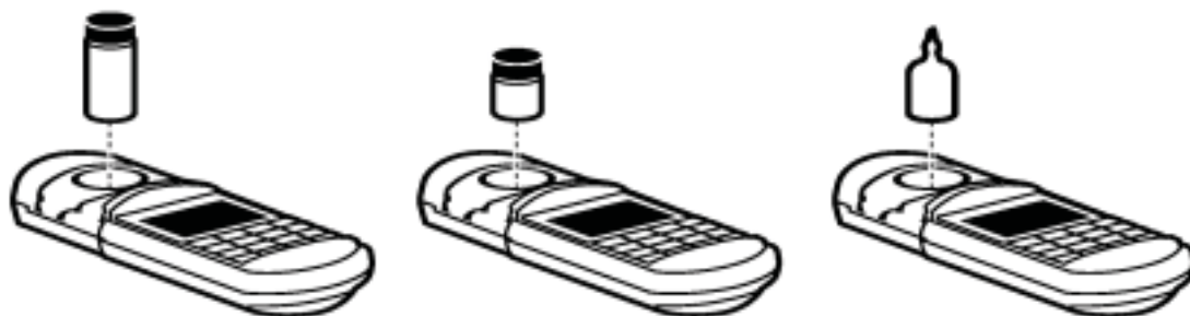
图 5 将样品放入样品池盒中
