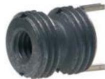
插销螺套,英文为key-locking threaded inserts,直译为中文即为键锁螺套,上世纪30年代由美国紧固件公司最先研制开发,自开发至今,已成功应用于航天航空、军工设备、铁路机械、电子电工等许多不同的领域和行业。这一产品的主要特征是在其外螺纹上有2-4根预组装键。
