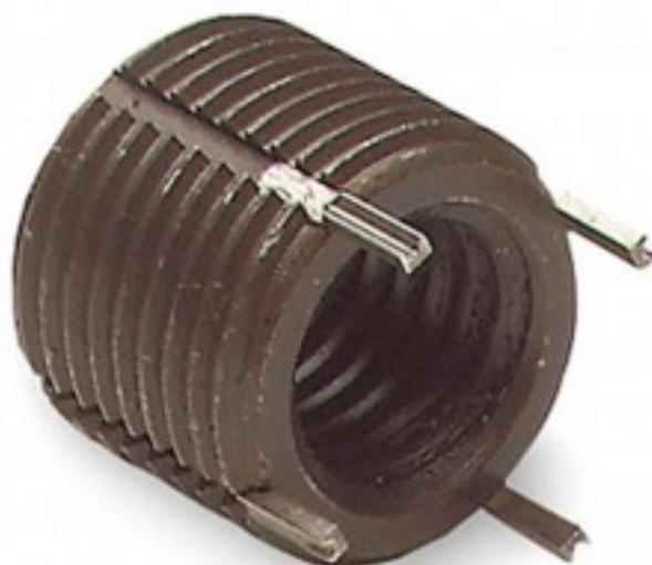
◆ 插销螺套可用于合金、轻质材料、钢和铸铁等低强度材料中增加螺纹强度，也可用于螺纹修复，受损螺纹修复后可以仍使用与原来相同的螺栓。
