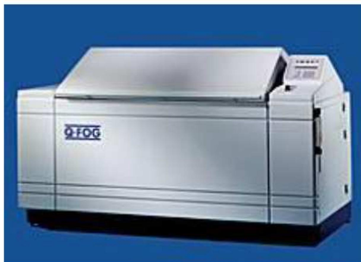
循环腐蚀盐雾试验比传统盐雾喷淋暴露试验更能真实反映实际使用结果
