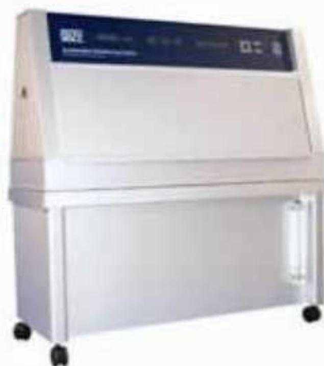
循环盐雾腐蚀和紫外光加速老化综合试验包含 1 周的 QUV 紫外光老化测试和 1 周的循环腐蚀试验。常被称为“Skerry 循环试验”
