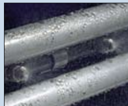
除了冷凝功能，QUV/spray 可以设置水喷淋循环用于模拟热冲击和（或）表面机械侵蚀。
