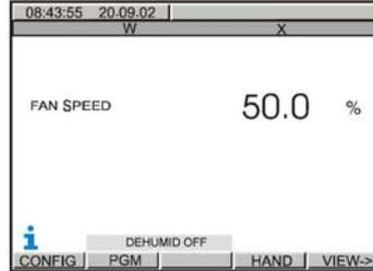
無加熱、無冷卻、無濕度控制，「X」代表「目前溫度」/「目前濕度」、「風扇速率」為 50%
