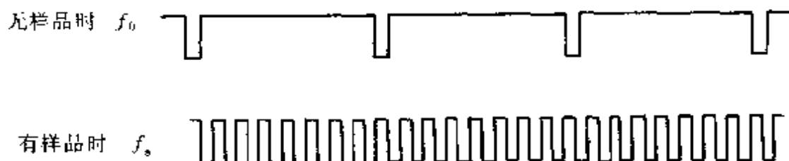
图 5-6 加在 ECD 池上的极化电压脉冲频率调制示意图
