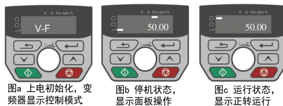
图 4-3 变频器初始化、停机、运行状态时的显示
