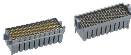
NeoScale™ 高速平行板系统 (左)：插头 (右)：插座 6 × 20 (120 个三元组)
