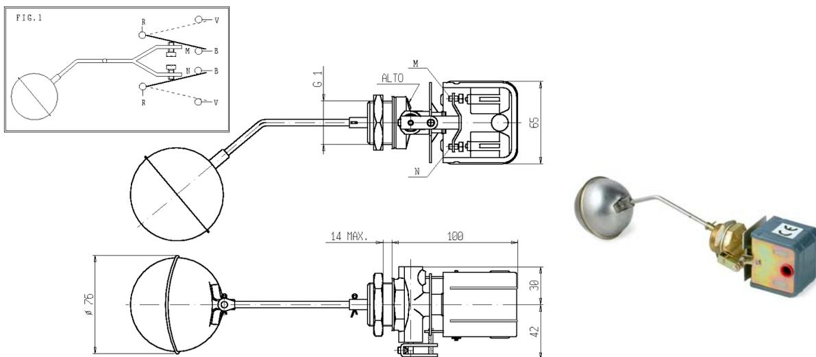
**CARACTERÍSTICAS** - Este instrumento se utiliza para el control o la regulación del nivel en recipientes sin o con presión. Hay dos interruptores eléctricos de desviación de tipo rápido y anti-vibratorio con contactos de plata: uno para el nivel mínimo, el otro para el nivel máximo.
