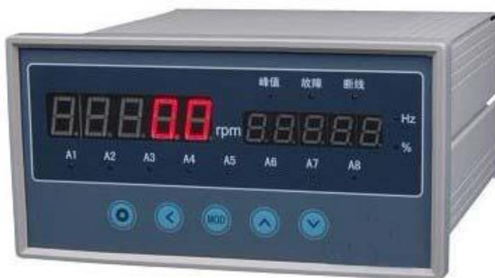
XSM 系列转速.线速.频率测量控制仪, 以测量输入信号的频率为基础, 配合表内可设置的参数, 适用于转速、线速、频率、脉冲信号流量传感器的瞬时流量等的测量、变换、显示、传送、记录和控制。
