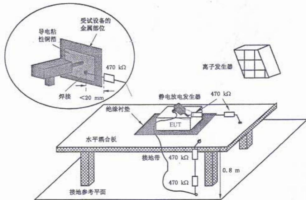
图 8 不接地台式设备的试验布置
