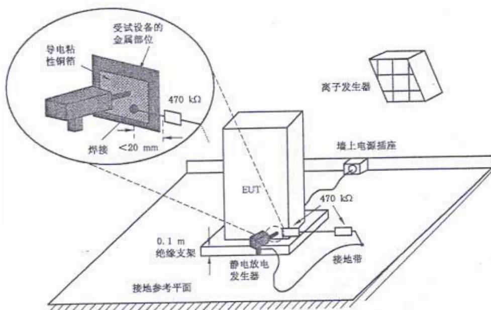
图 9 不接地落地式设备的试验布置
