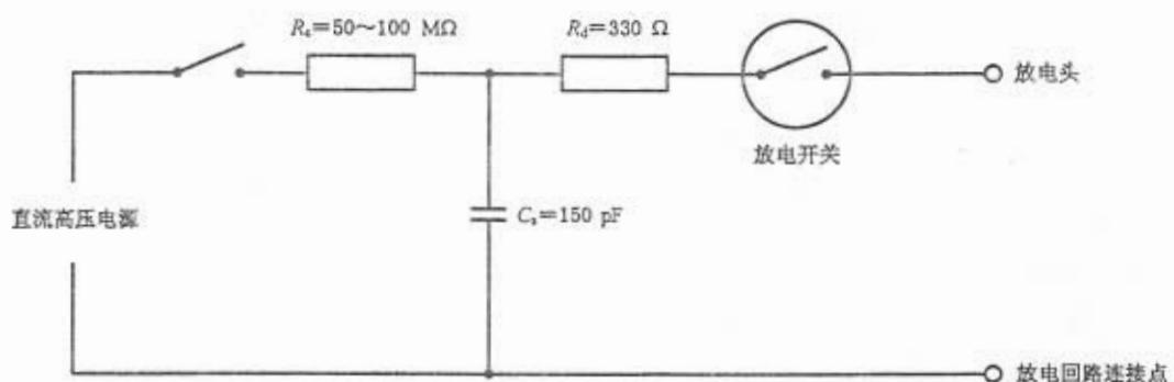
注：图中省略的  $C_d$  是存在于发生器与受试设备、接地参考平面以及耦合板之间的分布电容。由于此电容分布在整个发生器上，因此，在该回路中不可能标明。
