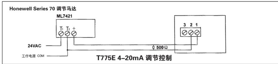
Series 70 电子式马达调节控制接线图
