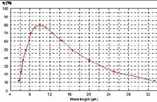
平面光栅 IR 机械刻划 | 75 l/mm | 闪耀 12.0 $\mu$ m
