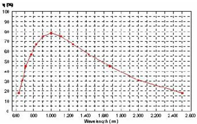
平面光栅 NIR 机械刻划 | 600 l/mm | 闪耀 300nm
