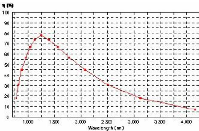
平面光栅 NIR 机械刻划 | 600 l/mm | 闪耀 1500nm
