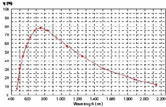
平面光栅 NIR 机械刻划 | 651 l/mm | 闪耀 1000nm
