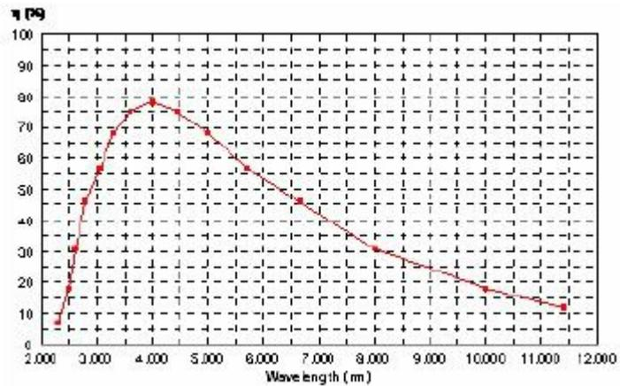
平面光栅 IR 机械刻划 | 150 l/mm | 闪耀 6000nm
