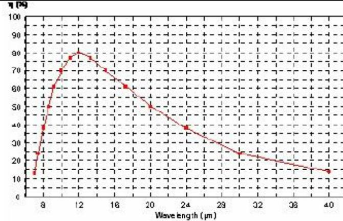
平面光栅 IR 机械刻划 | 54.2 l/mm | 闪耀 13.8 $\mu$ m
