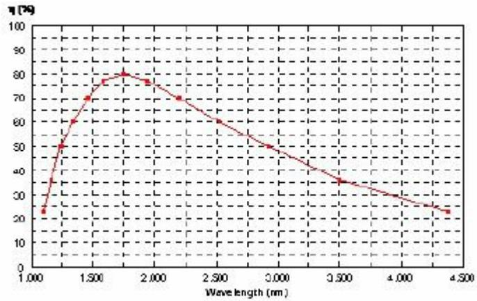
平面光栅 NIR 机械刻划 | 610.4 l/mm | 闪耀 1000nm
