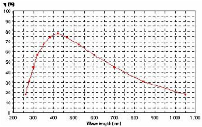
平面光栅 UV-VIS-NIR 机械刻划 | 651 l/mm | 闪耀 475nm
