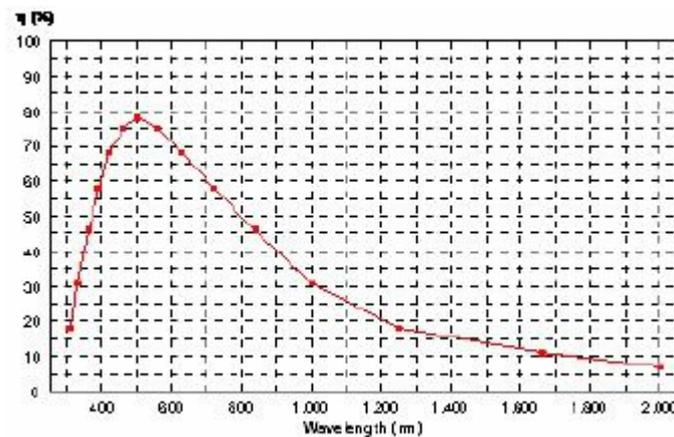
平面光栅 IR 机械刻划 | 150 l/mm | 闪耀 1270nm
