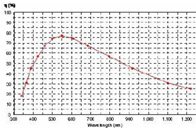
平面光栅 VIS-NIR 机械刻划 | 651 l/mm | 闪耀 750nm
