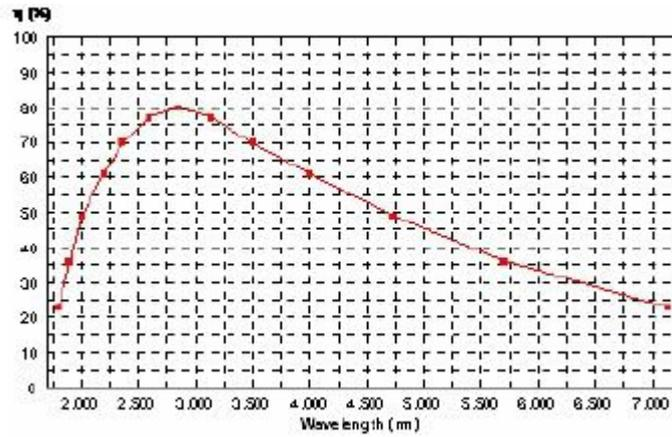
平面光栅 UV-VIS 机械刻划 | 162.75 l/mm | 闪耀 200nm
