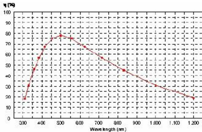
平面光栅 VIS-NIR 机械刻划 | 600 l/mm | 闪耀 1000nm
