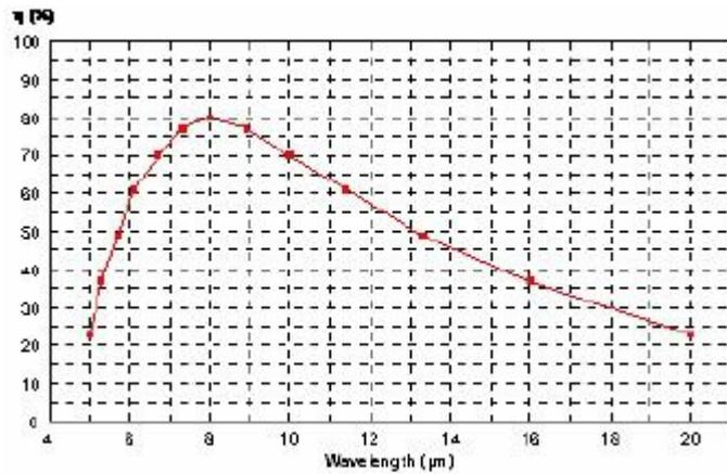
平面光栅 IR 机械刻划 | 75 l/mm | 闪耀 10.0 $\mu$ m
