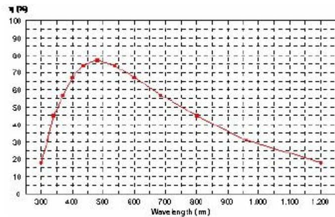
平面光栅 VIS-NIR 机械刻划 | 651 l/mm | 闪耀 550nm
