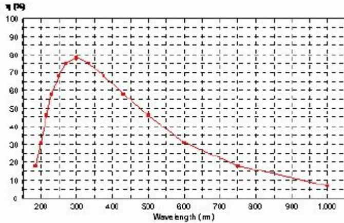
平面光栅 UV-VIS 机械刻划 | 325.5 l/mm | 闪耀 430nm
