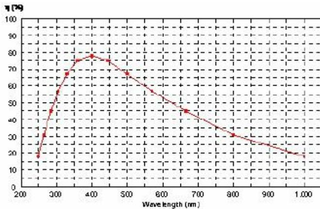
平面光栅 NIR 机械刻划 | 600 l/mm | 闪耀 400nm
