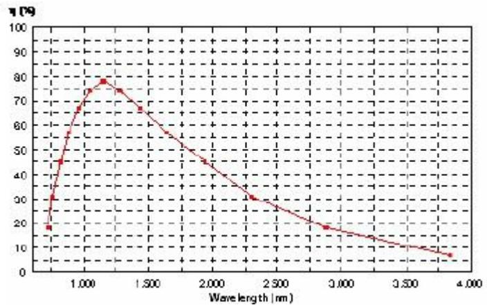
平面光栅 NIR 机械刻划 | 600 l/mm | 闪耀 1250nm
