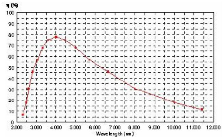
平面光栅 VIS-NIR 机械刻划 | 150 l/mm | 闪耀 500nm
