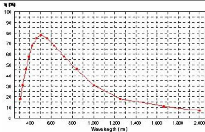
平面光栅 IR 机械刻划 | 24.1 l/mm | 闪耀 12.2 $\mu$ m
