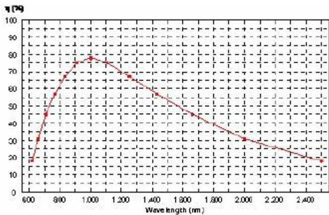
平面光栅 NIR 机械刻划 | 651 l/mm | 闪耀 1440nm
