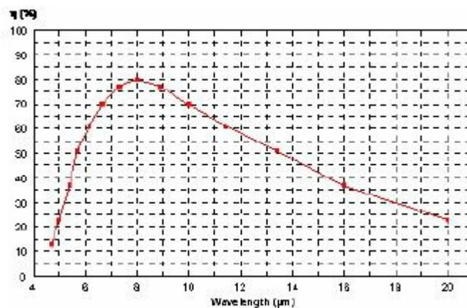
平面光栅 IR 机械刻划 | 75 l/mm | 闪耀 8.0 $\mu$ m
