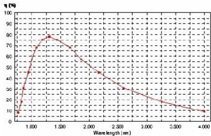
平面光栅 NIR-IR 机械刻划 | 300 l/mm | 闪耀 2850nm
