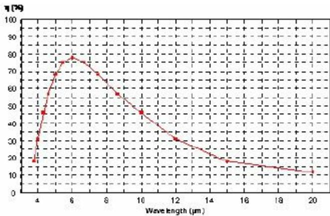
平面光栅 IR 机械刻划 | 130.2 l/mm | 闪耀 6.0μm
