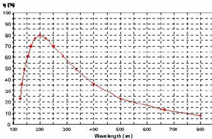
平面光栅 UV-VIS 机械刻划 | 162.75 l/mm | 闪耀 300nm
