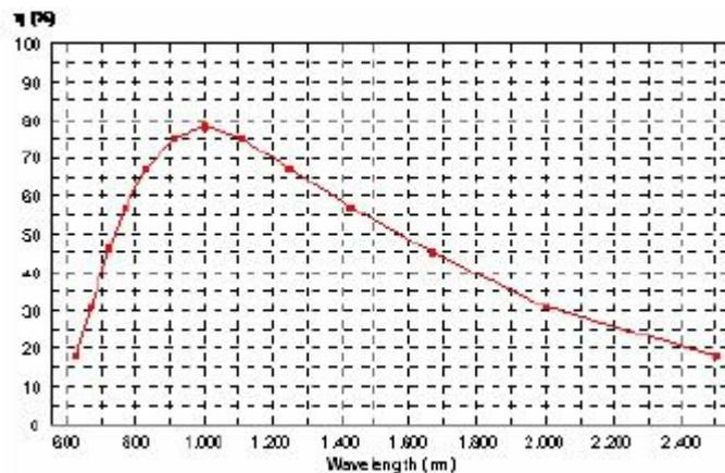
平面光栅 NIR 机械刻划 | 600 l/mm | 闪耀 1150nm
