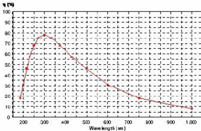
平面光栅 VIS 机械刻划 | 162.75 l/mm | 闪耀 480nm
