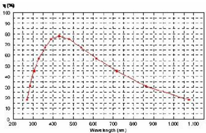
平面光栅 VIS-NIR 机械刻划 | 325.5 l/mm | 闪耀 550nm
