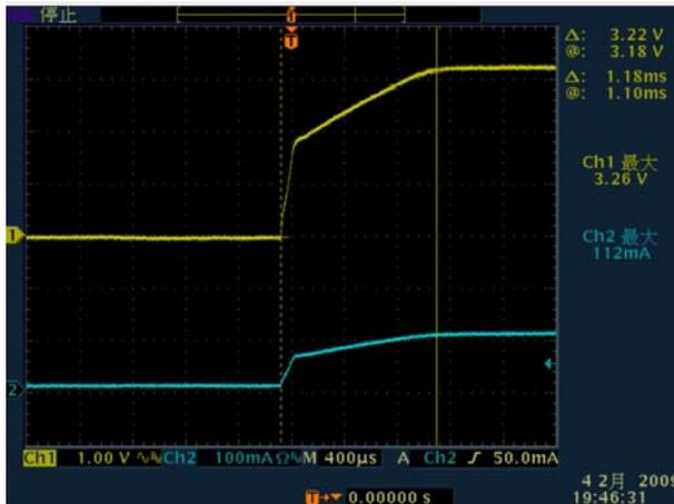
R=11Ω, IOUT=300mA, VIN=0~5V
