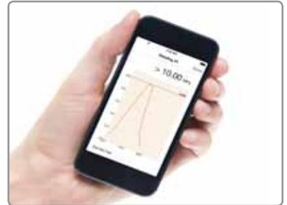
使用无线蓝牙® 通信链接测试仪到一个Android™或iPhone®手机设备，从您手机设备的GPS坐标可以添加到报告并通过电子邮件瞬间发送。
