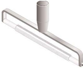
Abb. 4 Spiral-Filmziehgerät, Modell 358
