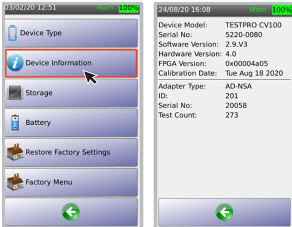
设备信息选项显示：设备型号、序列号、软件版本、硬件版本、FPGA 版本、适配器信息和
