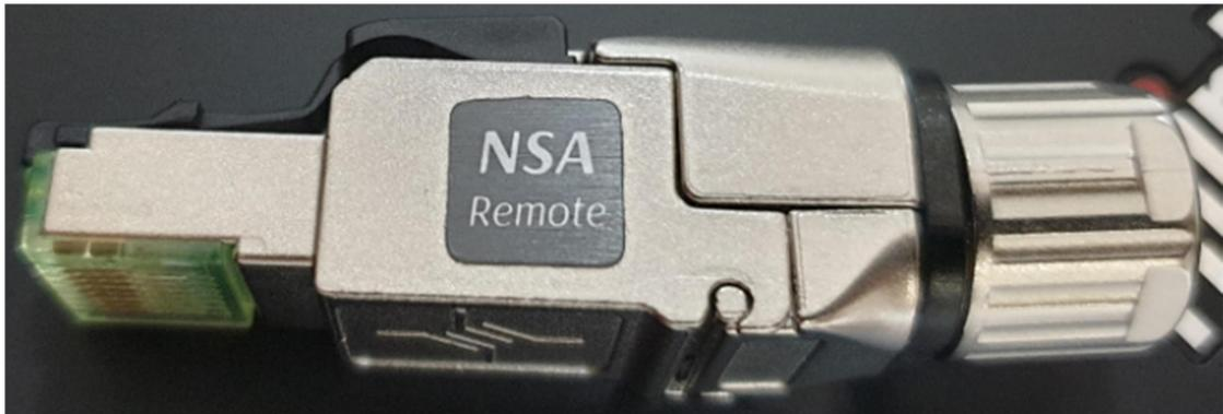
NSA 测试仪又称为“单端自动测试仪”，需采用 AD-NSA 适配器和远端模块。NSA 测试仪支持实时接线图、时域反射 TDR、长度、时延、回波损耗、近端串扰和其他功能。NSA 测试仪能自动识别 AD-NSA 适配器。
