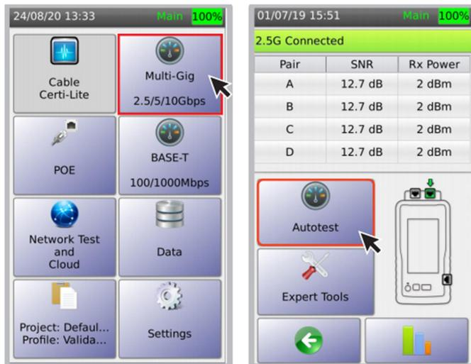
3 点击图标，启动多速率测试。作为快速测试，NSA 测试仪先以 2.5bps 的速率进行握手连接，如果握手成功，则显示在这个速率下，每个线对的信噪比（SNR）和信号接收功率。
