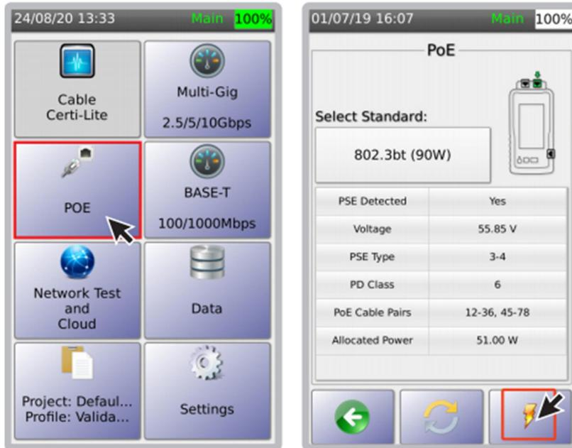
1. 选择[POE]图标，进入 POE 测试。 2 选择 POE 标准。此屏幕显示 POE 类型、电压和功率等级。仪表用实际连接的阻性负载测量功率。根据所选 POE 类型，自动探测用电设备(PD)等级。进一步的 POE 负载测试信息，可点击 ⚡ 图标查看。
