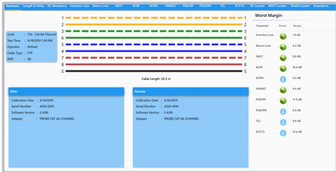
6 “摘要”显示接线图好测试数据摘要。“详情”显示每个线对的测试数据。
