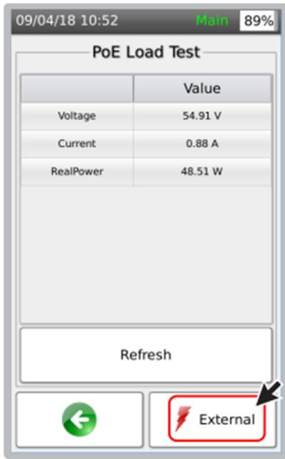
2 NSA 测试仪可以连接配合电源设备（PSE）的外部负载，将负载引线连接器至 AD-NSA 的红黑香蕉接口，点击[外部负载]。
