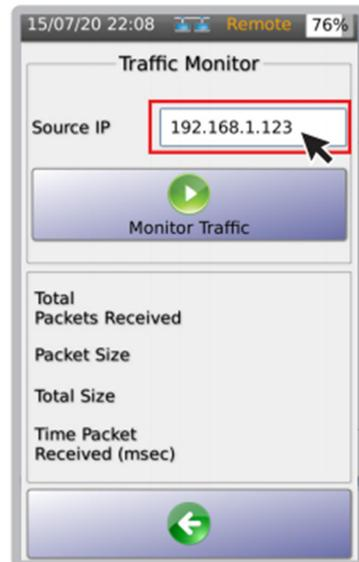
8 在“源 IP 地址”中输入发生数据包的 NSA 主机 IP 地址(网络分配给主机的 IP 地址，详见 P37 “查看设备详情”)
