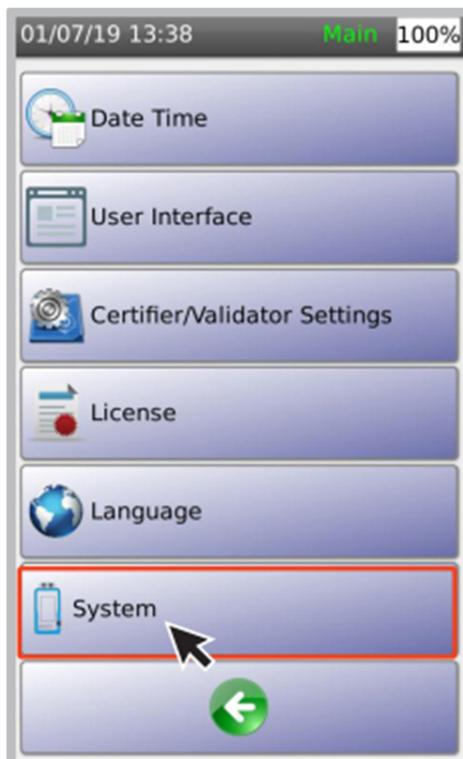
选择[系统]，设置仪表设备信息、存储、电池状态、恢复出厂设置。
