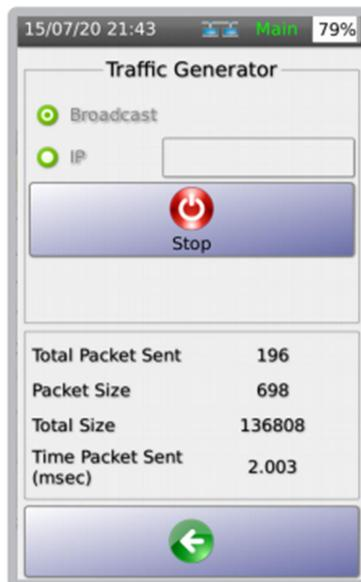
5 NSA 测试仪将生成流量数据包。发包总数、数据包大小、总字节数和发包时间将实时更新。
