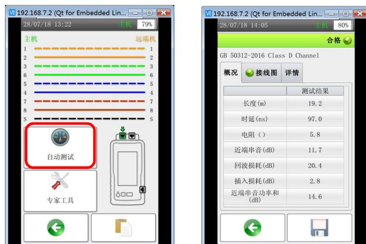
测试界面 (已自动测试接线图)
