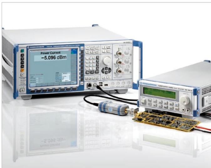
使用 R&S®NRP-Zxx 功率探头和R&S®NGMO2电源进行参考测量的测试配置
