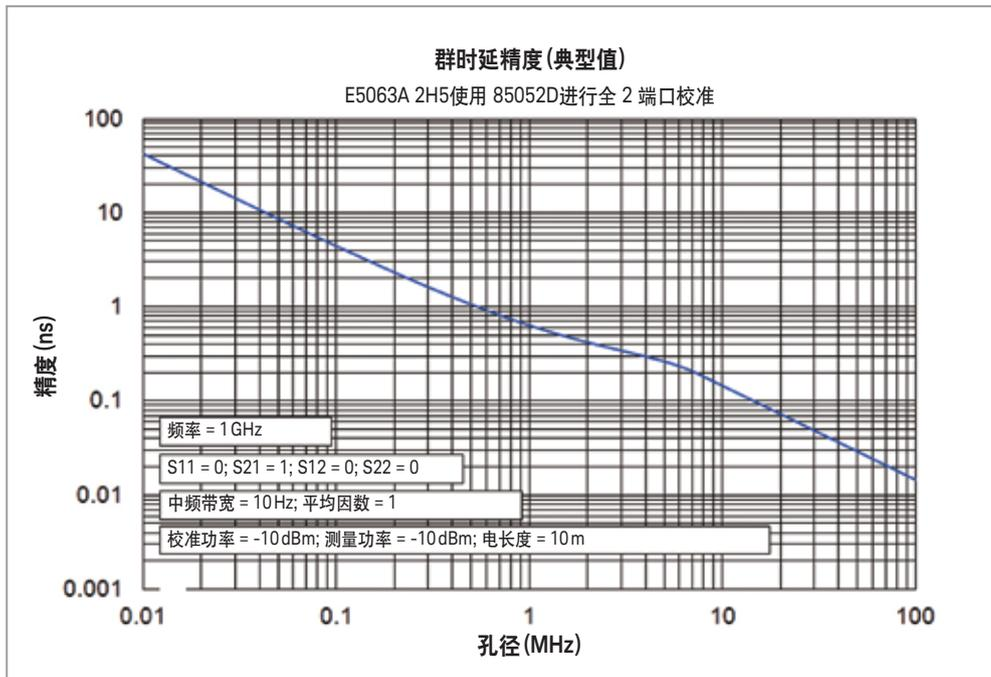
通常情况下, 使用以下公式可在几秒内确定特定群时延测量的精度:  $\pm$  相位精度(°)/[360 x 孔径(Hz)]
