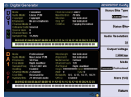
图2: 可以对 AES3/SPDIF 输出设置进行全面配置, 包括状态比特类型、状态比特、音频分辨率和输出电压; 可以将模式设置为“消费性电子 (Consumer)”或“专业 (Professional)”模式。
