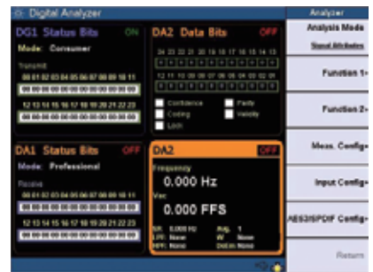
图3: 可同时查看多达四个显示 — 例如两个模拟、两个数字显示 — 同时进行多项分析。
