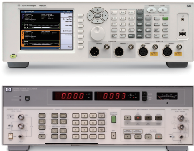
图 13. 新型 U8903A 音频分析仪 (顶部) 超越广泛使用的 HP 8903B (底部)，提供了多项改进。
