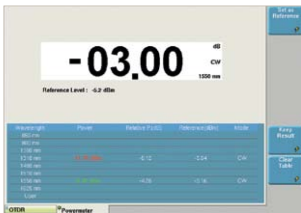
跳线损耗测试
