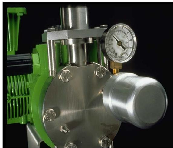
注意：带泄漏检测选件的计量泵从厂家发运时抽真空至 650 mm Hg（26 in.Hg）。在运输或储存时由于 TFE 隔膜的弯曲，泵启动后真空度可能会降低 250 mm Hg（10 in.Hg）。
