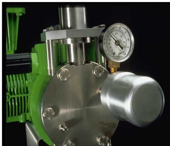
双隔膜、或夹心的、TFE 隔膜的外围密封一个金属环。隔膜中间被派空使隔膜功能如同单隔膜。隔膜中间连接一个可调真空操作压力开关（可选），在真空破坏时动作反映一片隔膜或两片隔膜破裂。开关的动作可用作任何功能，典型的如报价或停泵。
