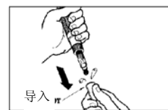
图 16 取下传感器顶端的充满液体的保护橡胶套
