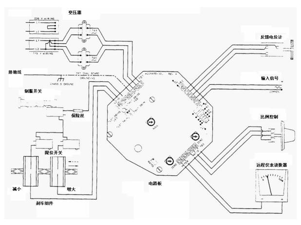
手动控制 一 远程手动冲程长度调节电位计。
