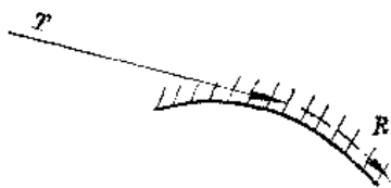
图 5-11 横波入射转换为表面波的情况
