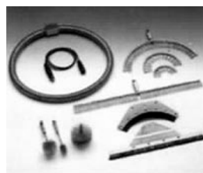
用于测量各种管材的特殊电极
