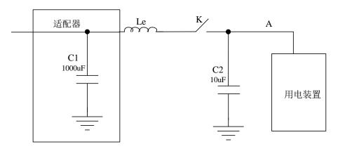
在上图中, C1为电源适配器的输出电容, 电感Le是电源线的等效电感; 电容C2是用电装置的输入滤波电容。开关K可以是用电装置的开关或者电源插头等。
