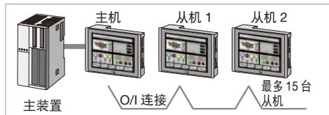
增设模块 通过荧幕显示与I/O控制一体化，削减工时、实现简单舒适的控制
