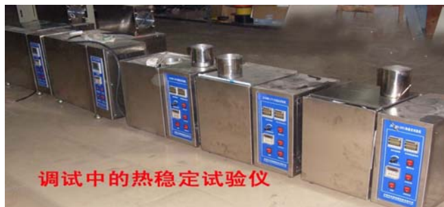
待调试的耐环境应力开裂、恒温油槽等
