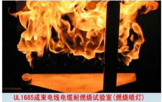
UL1685成束电线电缆耐燃烧试验室(燃烧喷灯)
