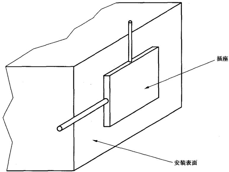
图 36 图 35 的量规的施加方向示意图
