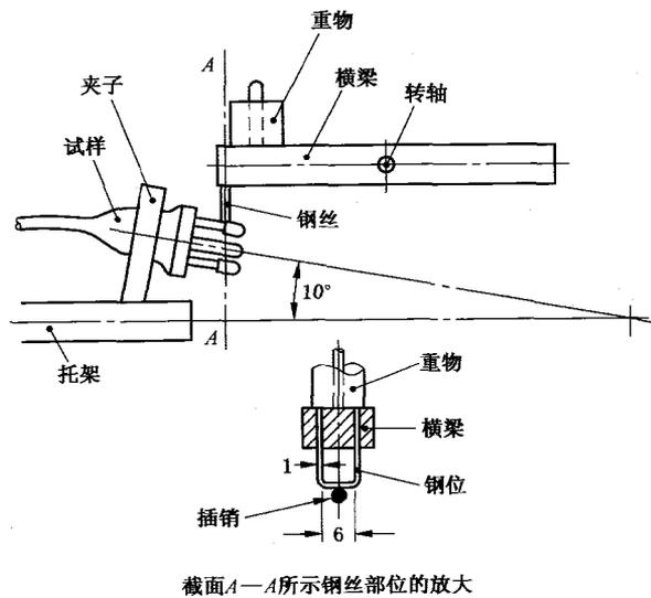
图 28 插头插销绝缘套上磨损试验用的装置
