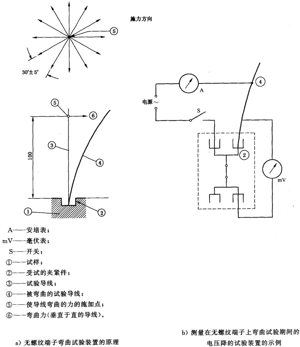
图 12 弯曲试验示意图
