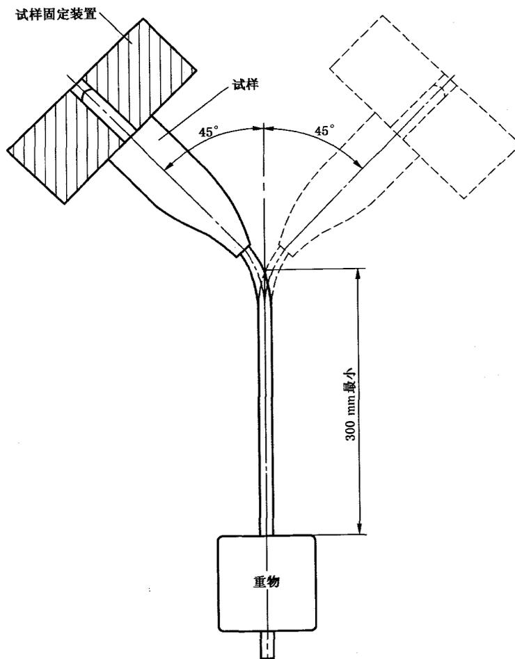
图 21 弯曲试验装置
