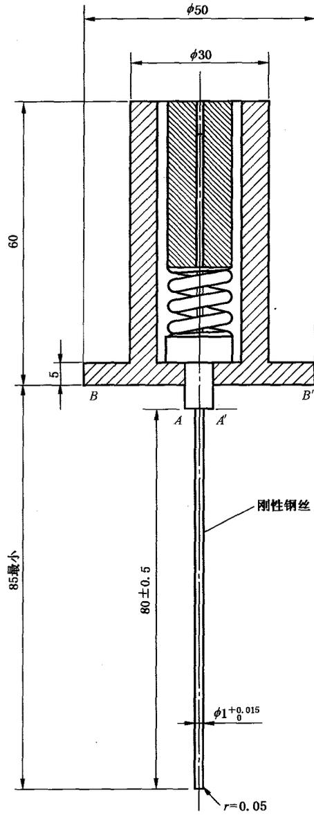
为校正探针,要朝刚性钢丝的轴的方向施加 1 N 的推力。探针的内弹簧应具有这样的特性,施加 1 N 的力时,能使表面 A—A'基本上与表面 B—B'齐平。
