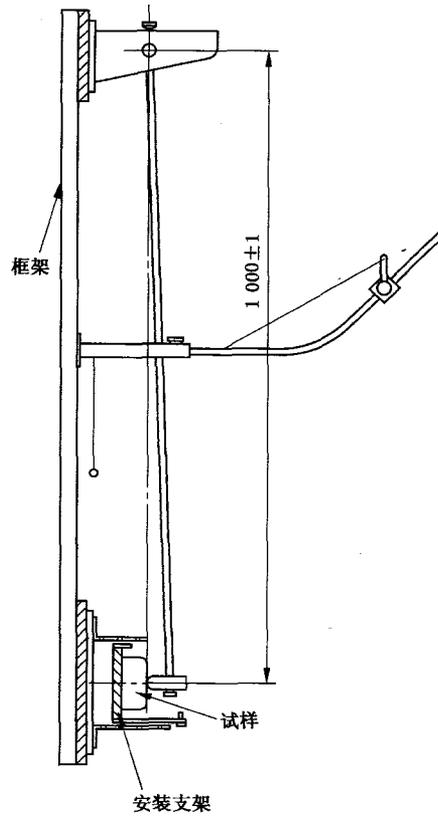
图 22 冲击试验装置
