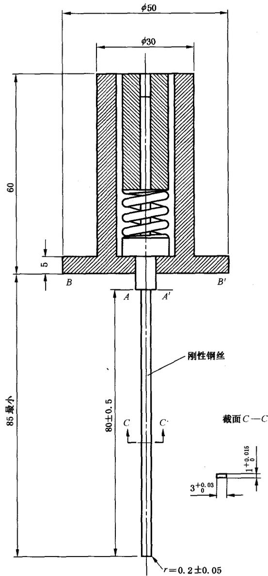
为校正探针,要朝刚性钢丝的轴的方向施加 20 N 的推力。探针的内弹簧应具有这样的特性:施加 20 N 的力时,能使表面 A—A'基本上与表面 B—B'齐平。
