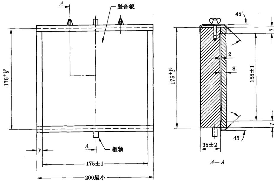
图 24 试样的安装支架
