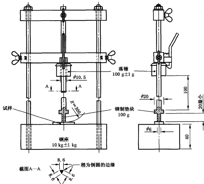
图 42 带有绝缘套的插销的冲击试验装置
