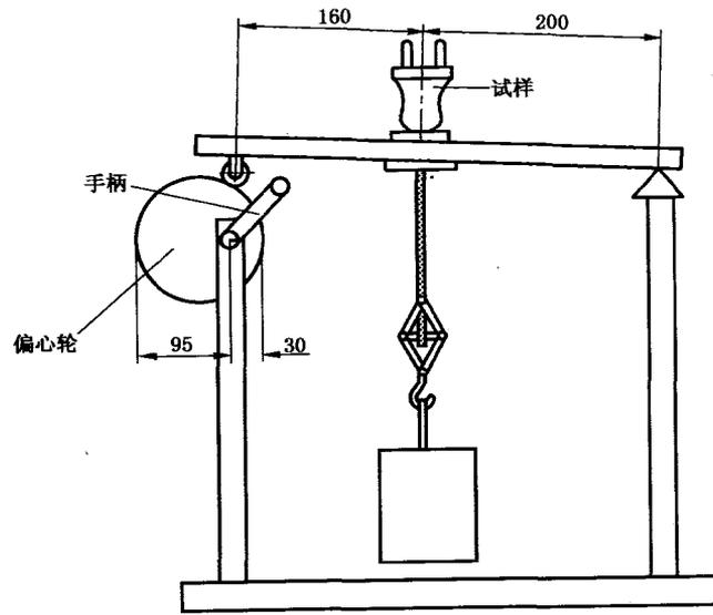
图 20 试验软缆保持力的装置
