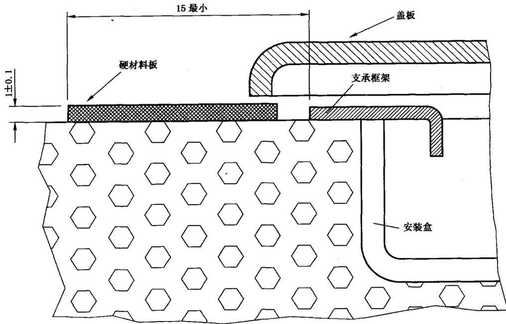
图 31 盖或盖板的试验装置
