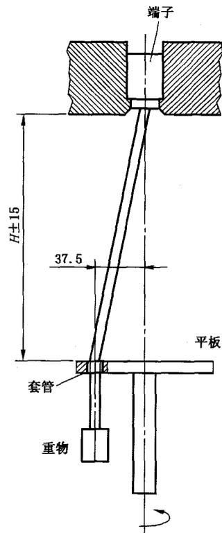
注：套管孔应能使作用于电缆的力是纯拉力，还应能避免将力矩传到夹紧装置里的导线。
