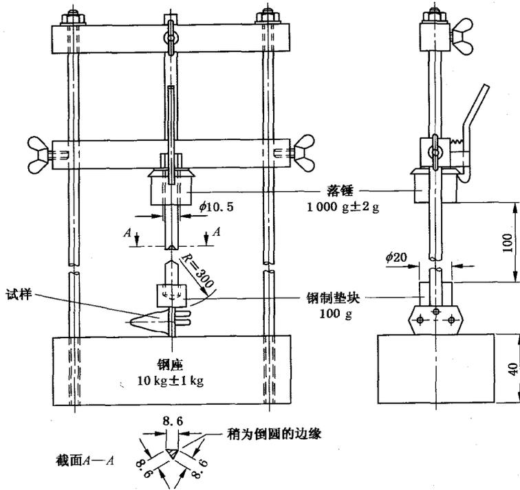
图 27 24.4 的低温冲击试验装置
