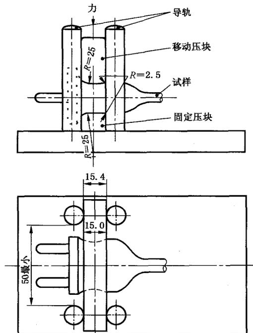
图 38 25.4 的检验耐热性能的压缩试验装置
