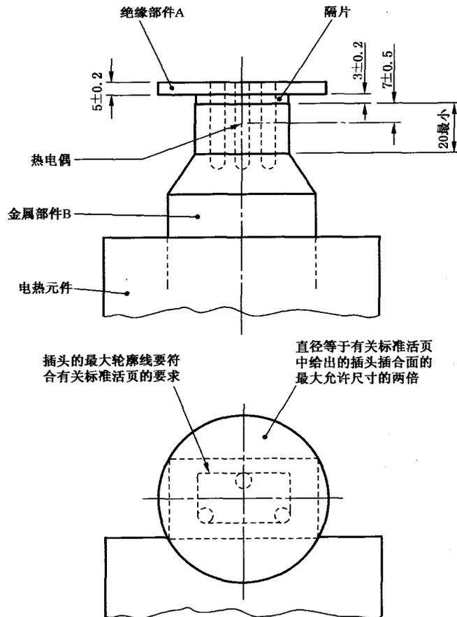
图 40 插头插销绝缘套耐非正常热试验装置
