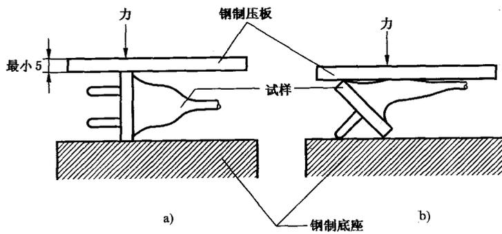
图8 24.5的压缩试验装置
