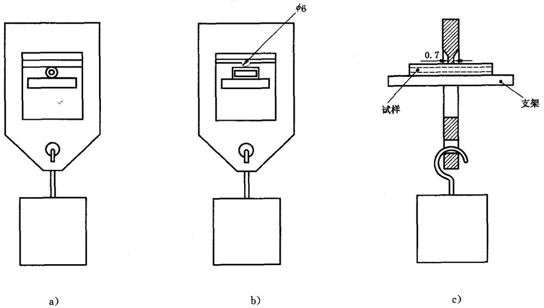
图 41 高温下压力试验装置
