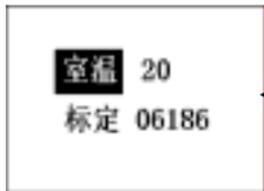
当测量信号为热电偶,需要内部冷端补偿时,需要标定室温,标定过程如下:现场测量出当前室温值,1.光标处于**室温**时,按"确认"进入输入室温值状态,此时"▶""◀"为移位键,按" " "加减当前的位值,按"确认"确定输入的室温值;2.按" " "光标移到**标定**处,按"确认"进入标定状态,过约 10 秒钟等到此标定值稳定后,按"确认"确定标定完毕。
