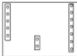
图中中间跳线短接时为电压输出，开路时为电流输出
