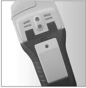
图3 可拆卸的电池板用一个螺丝固定。取下电池包时，逆时针旋转螺丝直至松开(该螺丝是固定的，因此会停留在电池包上)，然后可取下电池包。
