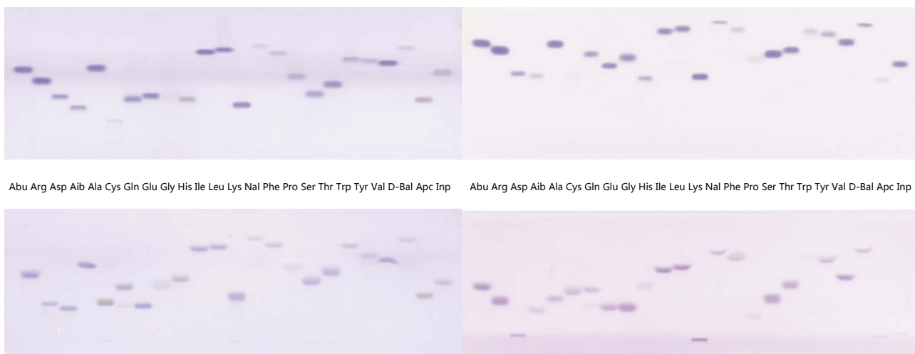
纤维素（左）和硅胶（右）固定相的分离结果比较，分别采用酸性（上）和碱性（下）展开剂
