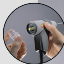
探头过滤器在进入烟道前过滤粉尘
