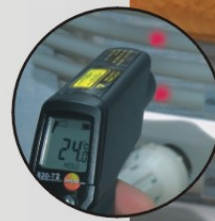
testo 830-T2, 2点激光瞄准(标示实测点)
