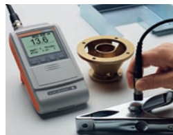
DUAL SCOPE® FMP40 – 测量小工件
