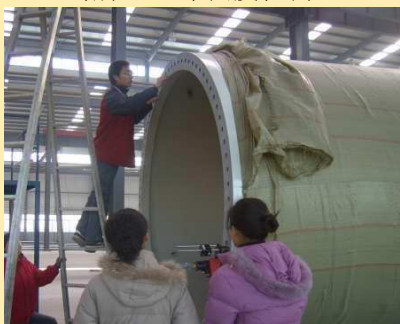
塔架法兰平面度检测
