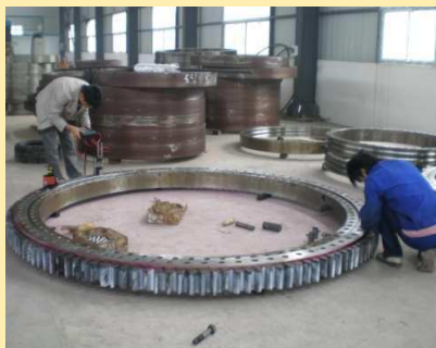
偏航、变桨轴承平面度检测
