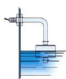
不锈钢浮子 直接装在容器壁上
