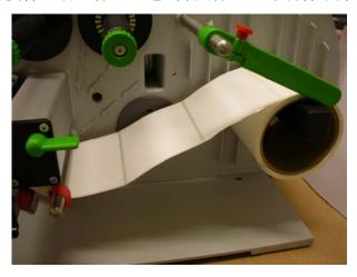
2. a3 的标签纸导引杆为单杆式设计,而 a4、a6、a8 则为双杆式设计,故安装时会有所不同, a3 的安装请参考上图, a4、a6、a8 安装如下图:
