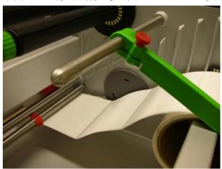
错误的安装 > 卷标纸未从卷标纸导引杆下方进入打印模块:
