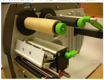
2. 于碳带供应轴一端安装新的碳带,从打印模块下方绕过印字头,切勿盖到标签纸感应器;
