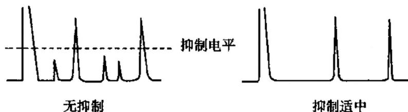
随着“抑制”作用的加大，仪器的动态范围将变得越来越小，因此，在实际探伤中有容易漏掉小缺陷的危险，故使用《抑制》功能时应根据探伤要求慎重考虑，以免造成不必要的漏检或误判。
